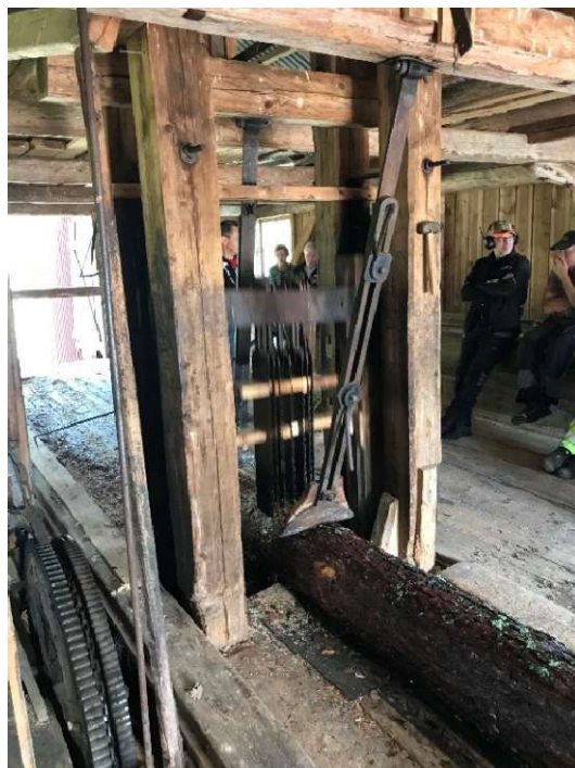
Foto 2. Stocken hålls ner av ställbart stöd, så att den inte åker med sågbladen upp.
