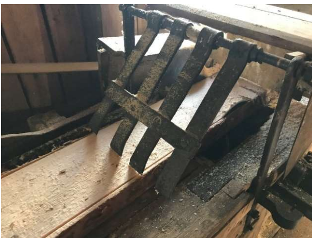
Foto 7. Plankan sågas. Plattstålen håller ner plankan.
