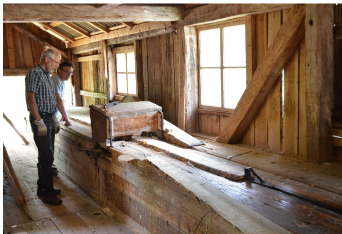
Foto 6. Plankan sågas. Bilden visar bl a påskjutningsklacken
