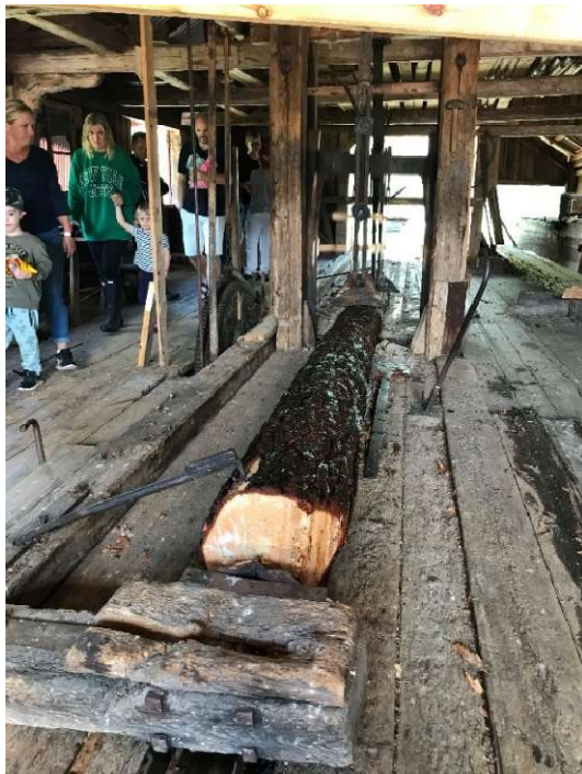
Foto 1. Stocken fäst mot sågsläden i rotänden.
