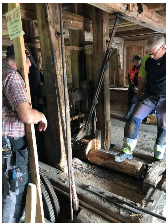
Foto 4. En liten stockbit används för att slutföra sågningen av den sista stocken.
